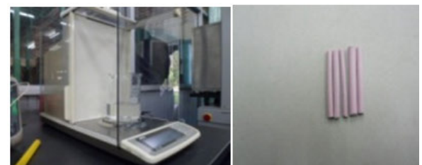
ภาพที่ 5 ชุดหาความหนาแน่นและชิ้นพลาสติกสำหรับการตรวจสอบหาความหนาแน่น
