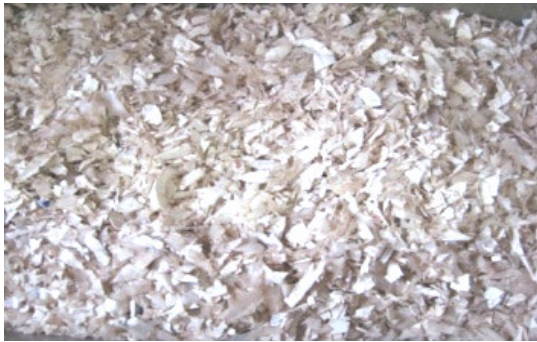
ภาพที่ 2 พลาสติกที่ผ่านกระบวนการย่อย ล้างและกระบวนการสไลด์แห้ง
