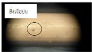
ภาพที่ 6 ลักษณะสิ่งเจือปนของเส้นพลาสติก
