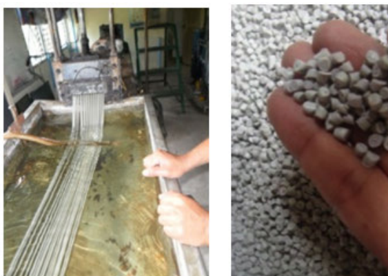
ภาพที่ 3 กระบวนการอัดรีดพลาสติกและเม็ดพลาสติกที่ได้
