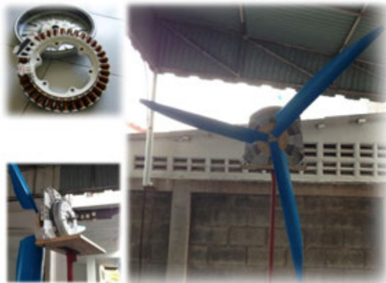
ภาพที่ 3 กังหันลมที่ผลิตจากมอเตอร์ Direct Drive
