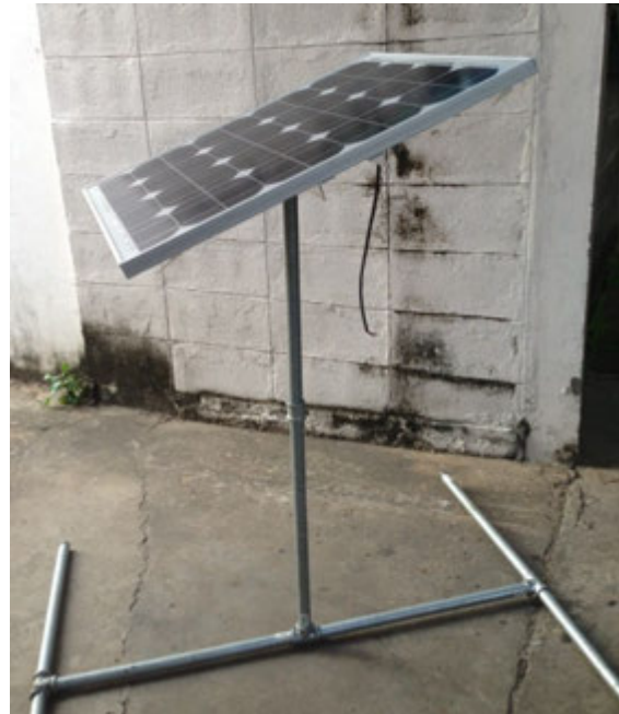
ภาพที่ 5 แผงโซลาเซลล์ขนาด 40 วัตต์ 21 โวลต์
