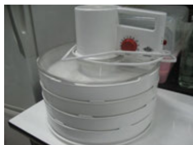
ภาพที่ 1. เครื่องอบแห้งเป่าลมร้อน (abc electro, Kirchheim-Teck, Germany)
