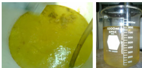
ภาพที่ 13 น้ำมันดิบจากขยะพลาสติกที่ผลิตได้
