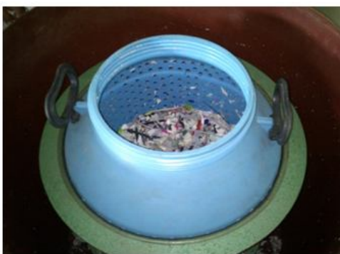
ภาพที่ 10 การสลัดพลาสติกให้แห้งโดยเครื่องสลัดแห้ง
