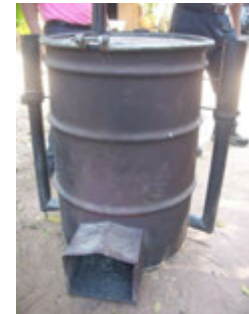
ภาพที่ 2 เตาเผาถ่าน 200 ลิตร ชนิดแนวตั้งแบบง่ายบ้านนาดี (ภาพซ้าย) และแบบมาตรฐาน (ภาพขวา)
