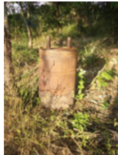
ภาพที่ 2 เตาเผาถ่าน 200 ลิตร ชนิดแนวตั้งแบบง่ายบ้านนาดี (ภาพซ้าย) และแบบมาตรฐาน (ภาพขวา)
