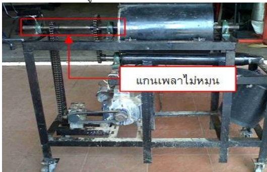
รูปที่ 3 เพลลาของใบพัดที่ใช้ผสมไม่หมุน
