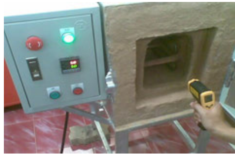
ภาพที่ 10 การวัดอุณหภูมิภายในห้องอบโดยใช้เทอร์โมมิเตอร์แบบอินฟราเรด
