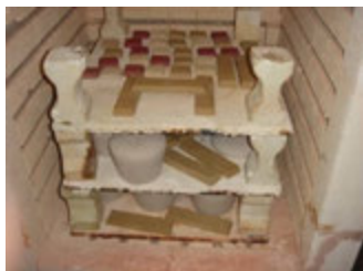
ภาพที่ 9 การนำแท่ง และแผ่นทดสอบสมบัติเนื้อดินบรรจุในเตาเผาเพื่อทดลองเผา
