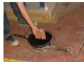
ภาพที่ 3 การนำแท่งทดสอบที่ผ่านการเผา มาต้มในน้ำเดือดเพื่อหาค่าการดูดซึมน้ำ
