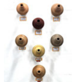
ภาพที่ 15 ชิ้นงานทดสอบที่ผ่านการเผาจากเตาเผาชุมชน จากอัตราส่วนที่เลือก
