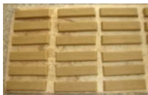
ภาพที่ 4 ลักษณะแท่งทดสอบการหดตัวของเนื้อดิน ที่กดอัดขึ้นรูปก่อนนำไปเผา
