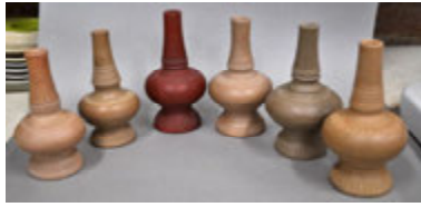
ภาพที่ 16 ภาพชิ้นงานที่ผ่านการผสมสารให้สีและเผาที่อุณหภูมิ 750 °c
