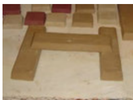
ภาพที่ 5 ลักษณะการวางแท่งทดสอบการโก่งงอของเนื้อดินภายในเตาเผา
