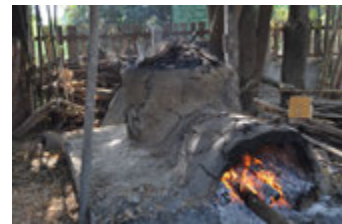
ภาพที่ 14 การนำชิ้นงานที่ผสมตามอัตราส่วนไปขึ้นรูปและเผาในเตาเผาชุมชน
