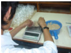
ภาพที่ 8 การชั่งส่วนผสมด้วยเครื่องชั่งตามอัตราส่วนและนำไปอัดขึ้นรูปในแบบพิมพ์
