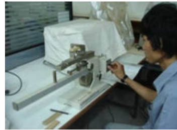
ภาพที่ 2 การนำแท่งทดสอบสมบัติของเนื้อดินเข้าเครื่องวัดความแข็งแรงการหัก
