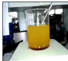
รูปที่ 2 การแยกชั้นของกลีเซอรินกับชั้นของน้ำมันดิบและเอสเทอร์
