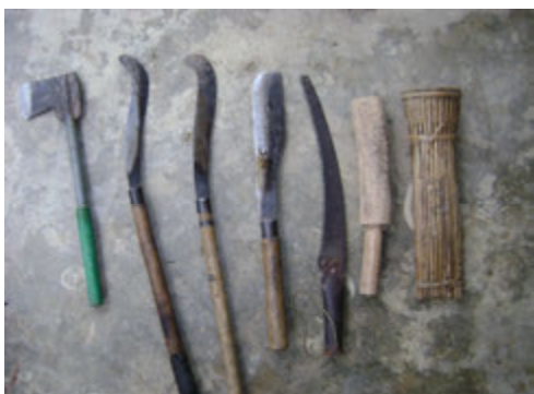
ภาพที่ 1 แสดงภาพของที่ใช้เป็นเครื่องมือหลักที่กลุ่มอาชีพผลิตผลิตภัณฑ์เครื่องจักรสานไม้ไผ่ใช้สำหรับการผ่าไม้ไผ่
