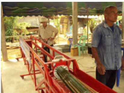
ภาพที่ 7 แสดงภาพการทำงานของตัวจับยึดลำไม้ไผ่
