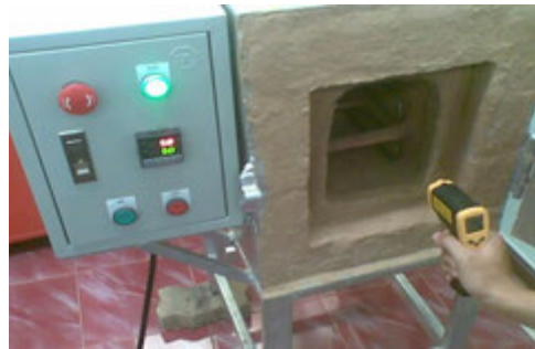
ภาพที่ 10 การวัดอุณหภูมิภายในห้องอบโดยใช้เทอร์โมมิเตอร์แบบอินฟราเรด
