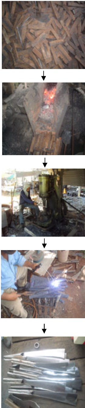
ภาพที่ 1 กระบวนการผลิตมีดพรา
