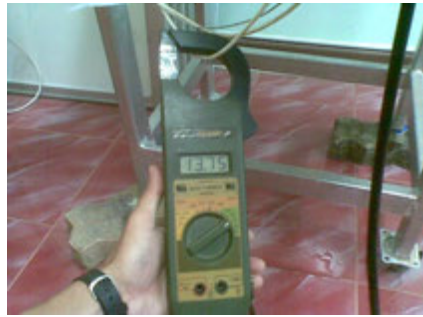
ภาพที่ 9 การวัดค่ากระแส
