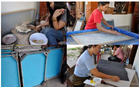
ภาพที่ 1 กระบวนการผลิตกระดาษจากปอสา โดยใช้ปอสาแห้งจากธรรมชาติ และใช้แรงงานคนเป็นหลัก
