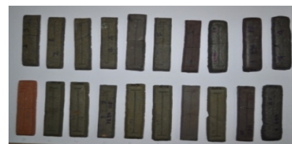
ภาพที่ 5 ผลการทดลองเนื้อกระเบื้องที่อุณหภูมิ 1230°C บรรยากาศในการเผา OF และ RF
