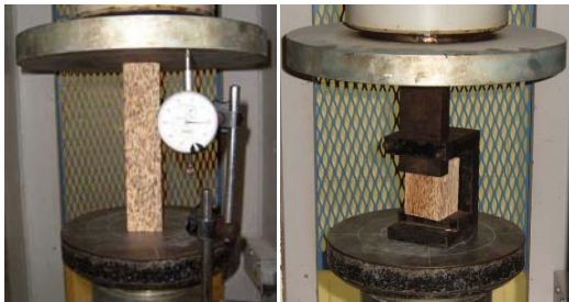
ภาพที่ 6 การทดสอบแรงอัด และแรงเฉือนขนานเส้น
