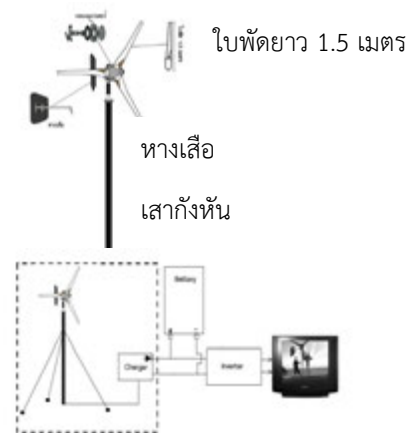
รูปภาพที่ 1 แสดงรายละเอียดอุปกรณ์เครื่องผลิตไฟฟ้าพลังงานลม
