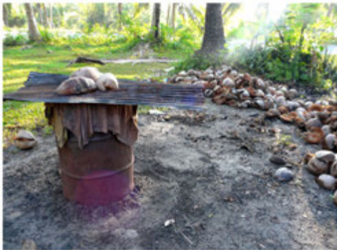
รูปที่ 1 การเผาถ่านกะลามะพร้าวในถังเหล็ก
