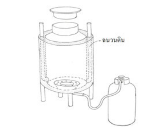
รูปที่ 2 โครงสร้างเตาเผาถ่านที่ใช้ในการทดลอง ตารางที่ 1 รายละเอียดทั่วไปของเตาเผาถ่านแบบเคลื่อนที่ได้
