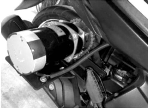
ภาพที่ 4 ตำแหน่งติดตั้งชุดมอเตอร์ขับเคลื่อน
