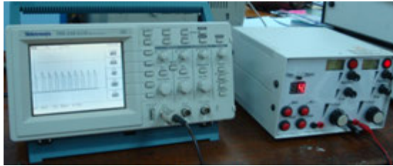
ภาพที่ 3 การต่อวัดรูปคลื่นเอาต์พุตของเครื่องกระตุ้นกล้ามเนื้อ
