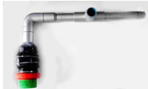
ภาพที่ 6 ชุดเครื่องอัดอากาศและแอร์เจ็ทปั๊มที่ได้ออกแบบ
