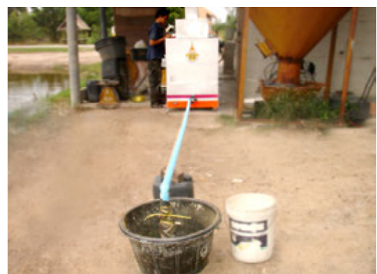
(ข) การติดตั้งเพื่อทดสอบการทำงานของเครื่องให้อาหารปลา
