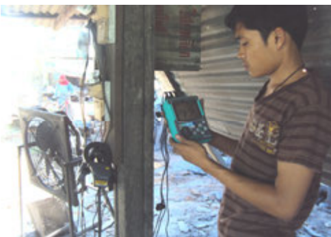
ภาพที่ 12 การบันทึกผลข้อมูลด้วยเพาเวอร์มิเตอร์ยี่ห้อ KYORITSU MODEL 6300
