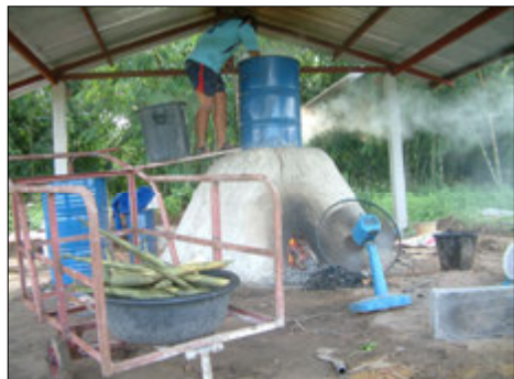
ภาพที่ 2 การทดสอบเตาต้มหน่อไม้ด้วยวิธีการเผาถ่าน
