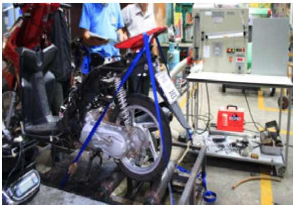
รูปที่ 20 การวัดค่าสมรรถนะของเครื่องยนต์
