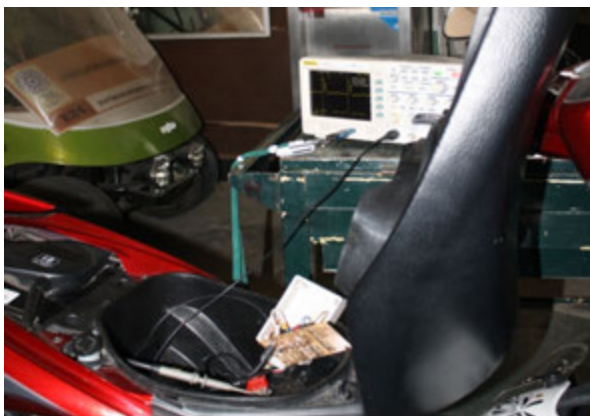
รูปที่ 5 การวัดคลื่นสัญญาณที่หัวฉีด
