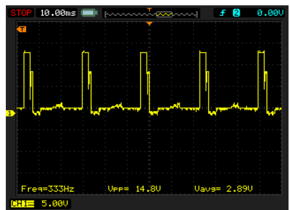
รูปที่ 27 สัญญาณที่วัดที่หัวฉีดเมื่อต่อกล่องใหม่ขนานกับกล่อง ECM
