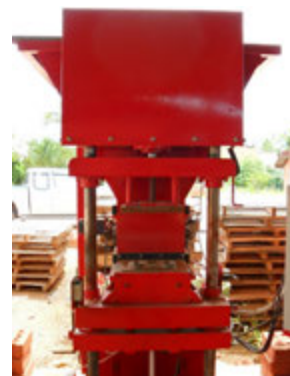
รูปที่ 4 เครื่องอัดขึ้นรูปอิฐบล็อกประสาน
