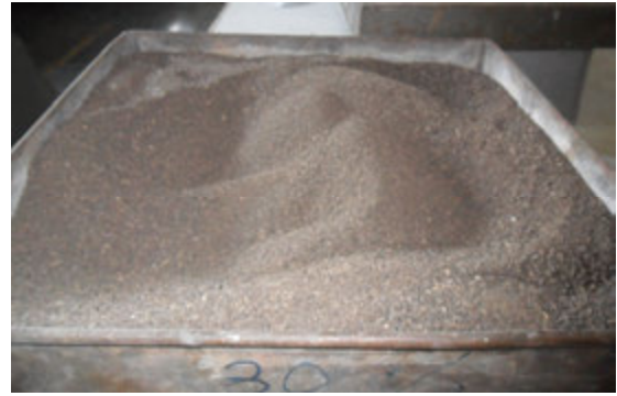
รูปที่ 3 กะลาปาล์มที่ร่อนผ่านตะแกรงเบอร์ 8
